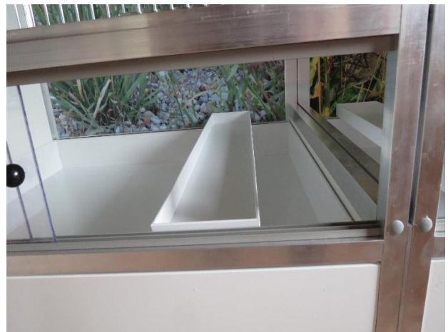
Beim Boxenbau werden Verbundplatten, Polycarbonat und Polystyrolplatten verarbeitet
